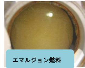
脱臭バーナにはエマルジョン装置を採用。化石燃料(A重油)にミクロの水滴を均一に分散させているため、大幅に燃焼効率を向上させることができます。A重油を燃焼させたときと比較して、二酸化炭素、硫酸化合物、窒素化合物の排出量を削減できます。
